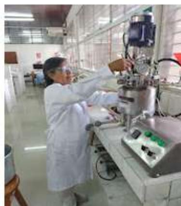
Ensayos en reactor de hidrogenación de aceite
